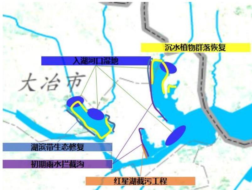
附图 7 大冶湖水生态修复工程（大冶部分）布置示意图
